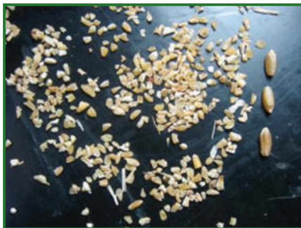
دانه شکسته‌شده در کوبنده کمباین کاه کوب
