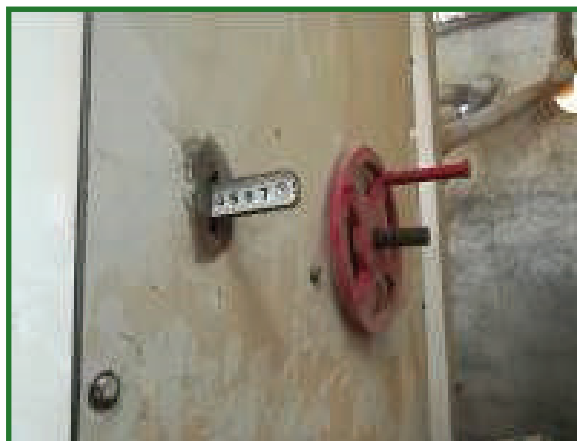
تنظیم سرعت دورانی و فاصله دریچه ماشین لایه‌بردار سایشی کینوا
