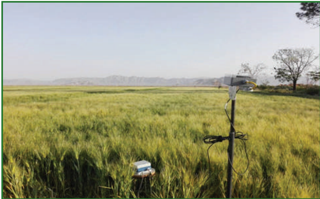
نصب سنسورهای پایش رطوبت با فرستنده بی‌سیم در مجاورت سنسورهای داخلی در کشت جو
